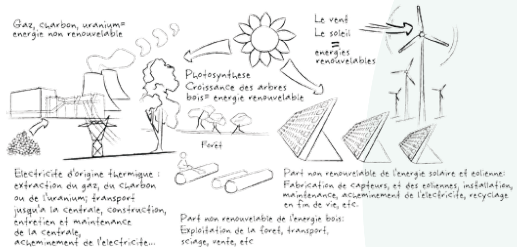
Figure 10 - Exemples illustrant les besoins en énergie pour la production et la distribution d'énergie. Source : GT ICEB
